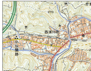
▲2 電子地形図25000の表現例 道路は種類ごとに色をかえることができ、高速道路、国道、県道が異なる色で塗られている。また、地形の凹凸を読み取りやすくするために、陰影がついている。
