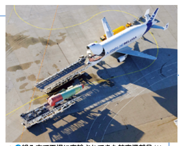
④組み立て工場に空輸されてきた航空機部品(ドイツ、ハンブルク) エアバス社には、航空機の大きな部品を輸送するための専用貨物機があり、各国で生産された部品を組み立て工場に空輸している。
